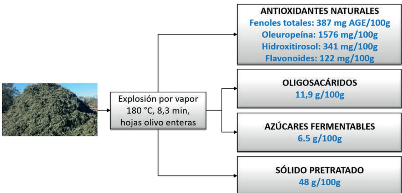
Figura 5. Ejemplo de biorrefinería basada en las hojas de olivo.
