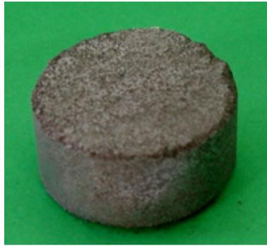
Figura 2. Ejemplo de tableta de manganeso (85%), utilizando aluminio como elemento aleante.
