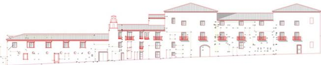
Plano de fachada principal dibujado con AutoCAD 2012 a partir de la fotogrametría y de la perspectiva inversa.
