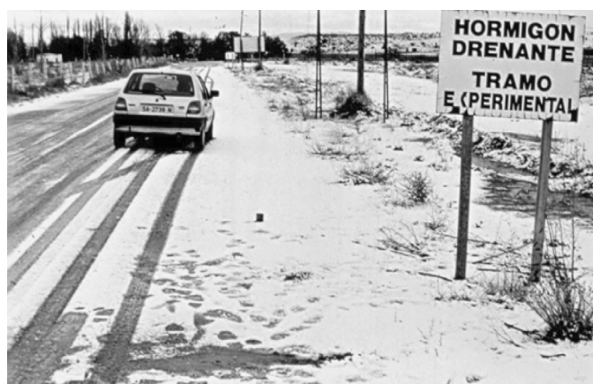
Figura 4. Pruebas de frenado en el primer tramo experimental de carretera de HPAP de la figura 1 tras una nevada.
