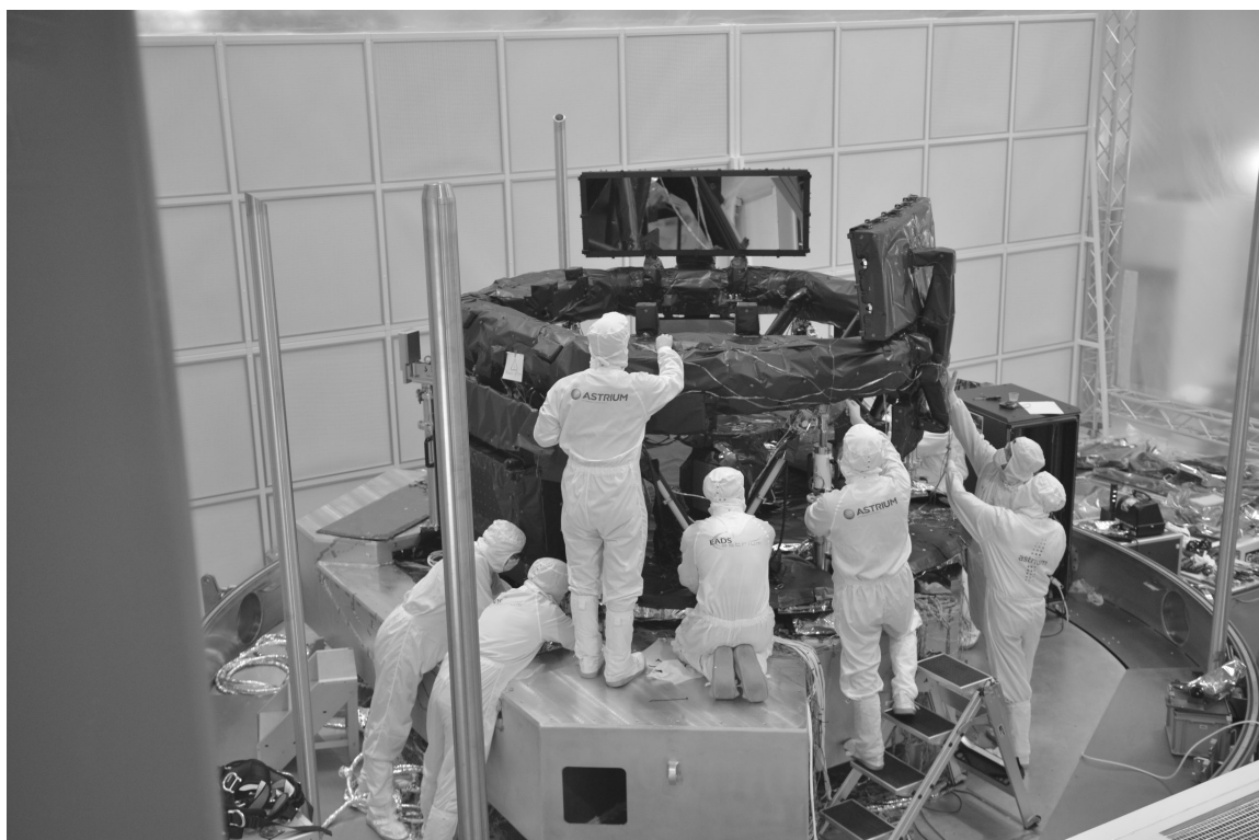
Imagen del Módulo de Carga Útil del Modelo de Vuelo de Gaia durante los ensayos térmicos. Fuente: Astrium SAS
