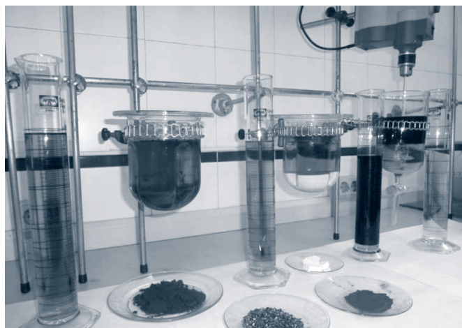
Foto representativa del proceso de recuperación de litio de las pastas de batería.
