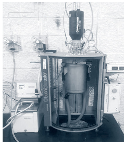
Sistema reactor Buchi para hidrólisis de biomasa y transformación en commodities químicos.
