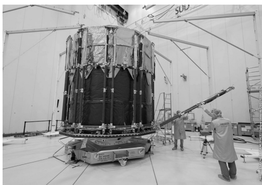
Pruebas del parasol desplegable del satélite Gaia ©ESA.
