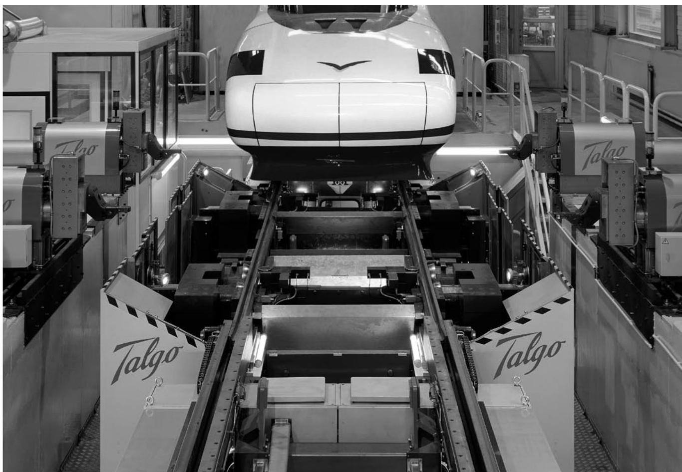
Foto 7. Torno de foso para torneado y reperfilado de ruedas sin desmontar.
