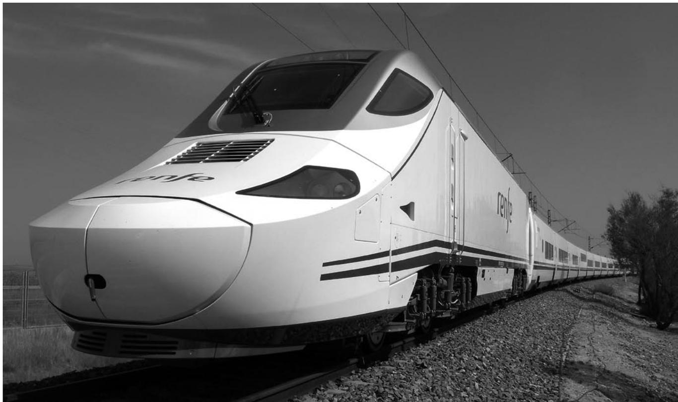
Foto 6. Tren Talgo Alta Velocidad con cambio automático de ancho de vía, serie 130, en servicio.
