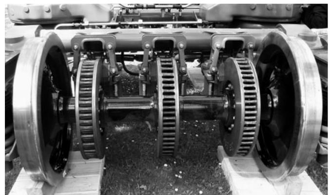
Foto 9. Bogie y eje convencional, ruedas caladas sobre un mismo eje
