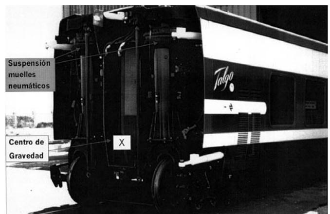
Foto 11. Talgo Pendular suspensión neumática y posición de amortiguadores longitudinales
